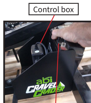
Fig 6. Control box 12 volt battery
